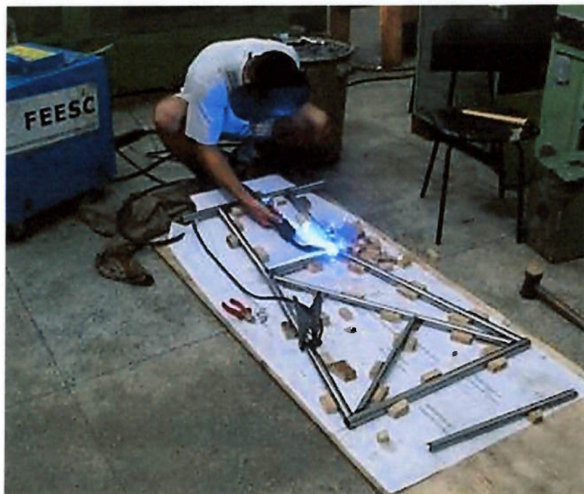
Figura 67: Ilustração da fixação das barras sobre o desenho em escala 1:1
