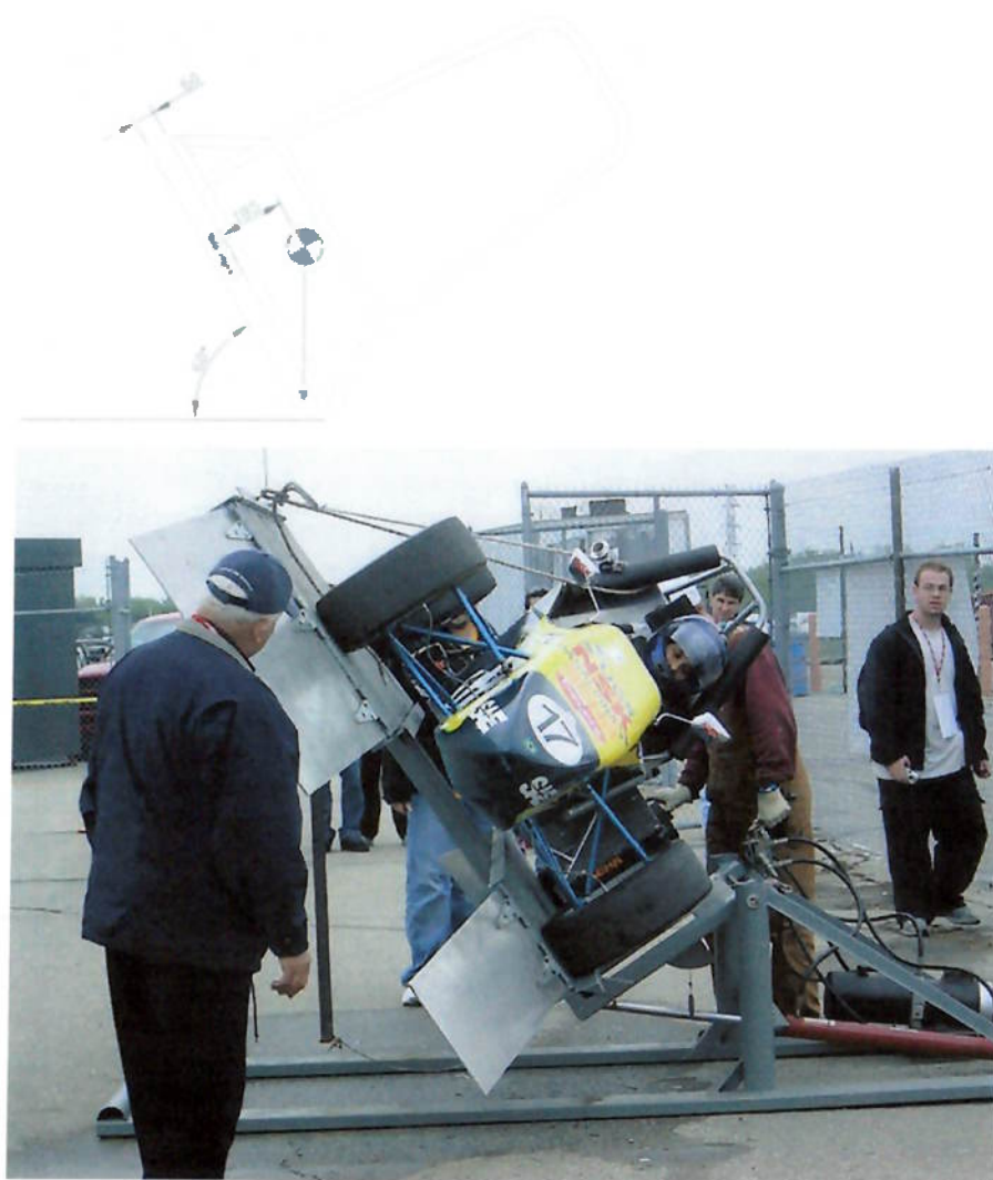
Figura 74 - Teste de inclinação de 60° do veículo
