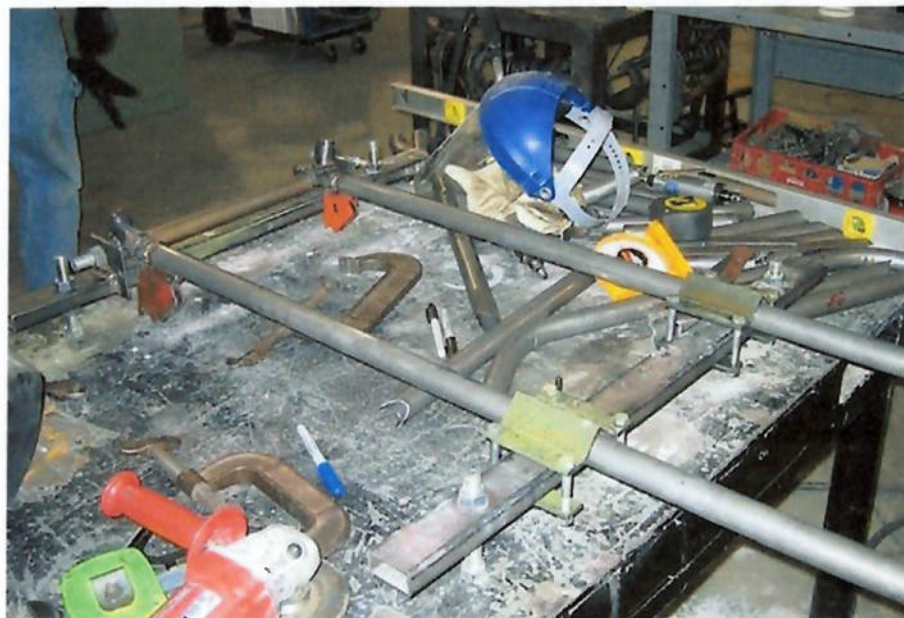
Figura 69: Exemplo de fixação dos tubos.
