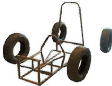
Figura 68: Ilustração da preparação dos planos da dianteira do veículo para soldagem
